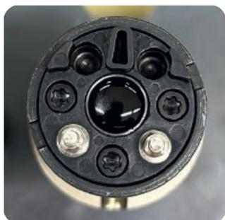
No. - El tapón de resina epoxi sella el regulador después del ajuste de fábrica Ajuste básico. Existe riesgo de daños en el motor si Se cambia la configuración.
