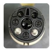
Nein. - Die Epoxidharzkappe versiegelt den Einsteller nach der werkseitigen Grundeinstellung. Es besteht die Gefahr eines Motorschadens, wenn die Einstellung verändert wird.
