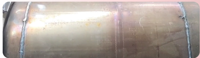
SCR-Substrate ersetzt, aber keine Angabe der Typgenehmigungs- oder Homologationsnummer.
