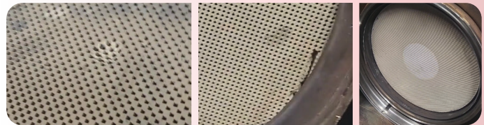
DPF hat Risse, durch die Abgase entweichen können, und hätte ausgetauscht werden müssen.
